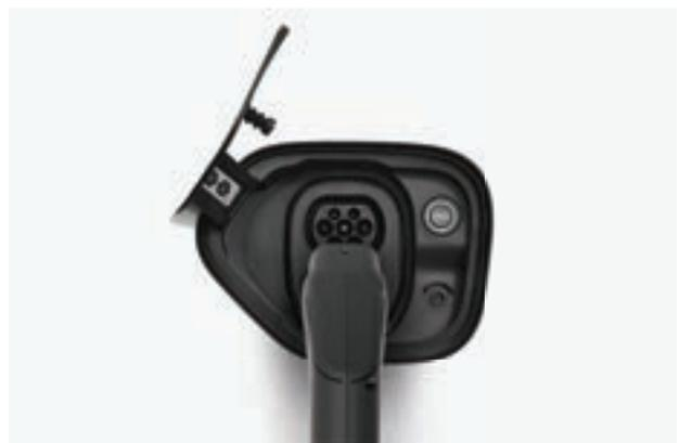
Insérez le connecteur dans le port de charge de la voiture (à 4 mètres maximum du One).
