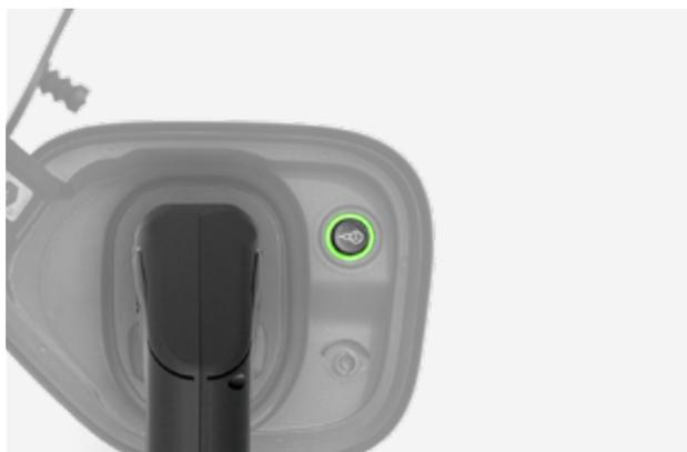
Interrompez le processus de charge du côté du véhicule et retirez le connecteur (cette étape est spécifique au véhicule).
