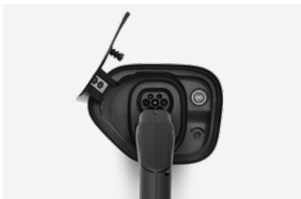
Plaats de andere zijde van de laadkabel in de laadpoort van de wagen.
