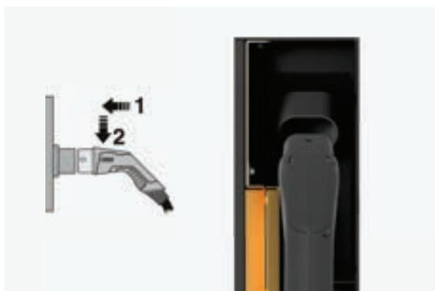
Insérez le connecteur dans le berceau du Wall Plus.
