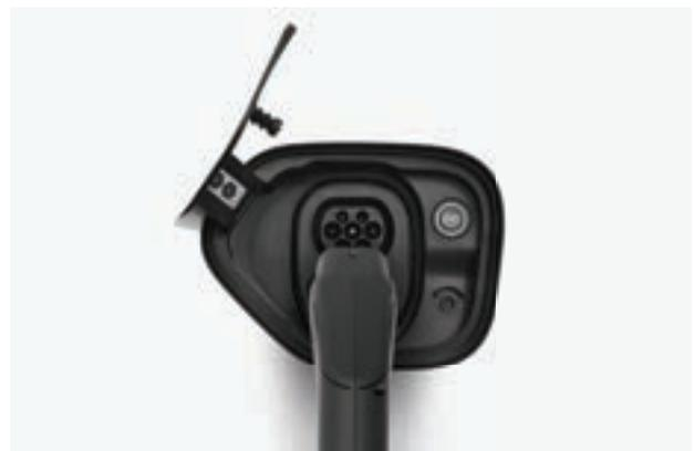
Insérez le connecteur dans le port de charge de la voiture.
