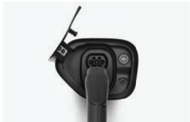
Plaats de andere zijde van de laadkabel in de laadpoort van de wagen.
